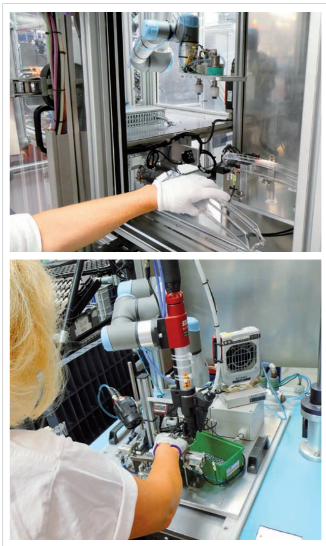
V ZKW Slovakia sú nasadené štyri kolaboratívne roboty, ktoré pomáhajú s manipuláciou (hore) či skrutkovaním (dole).
