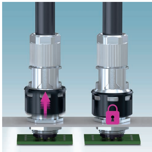
Obr. 2 Ľahko zasunuté a spoľahlivo zaistené: konektor sa odpruží späť, ak nie je správne zaskočený na miesto (vľavo), alebo sa uzamkne kliknutím, ktoré je počuť.
