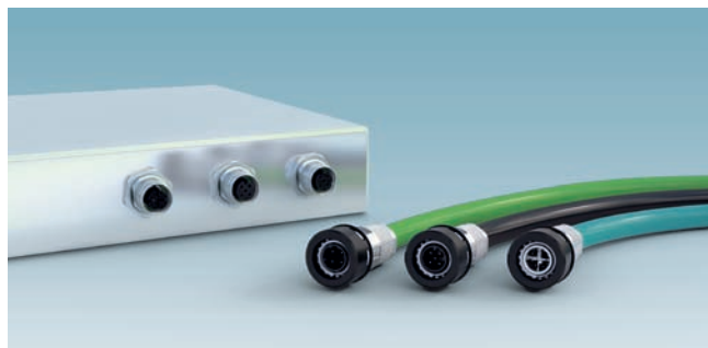
Obr. 3 Jednotné a konzistentné riešenie pripojenia na prenos signálu a dát: konektory s kódovaním D (vľavo), kódovaním A (v strede) a kódovaním X (vpravo)
