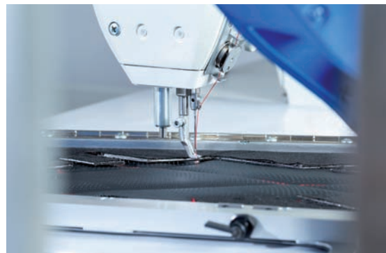
Robot zavádza pozoruhodnú presnosť procesu šitia a umožňuje vytvárať nové dizajnové prvky v interiéri vozidla. (Zdroj: YASKAWA)
