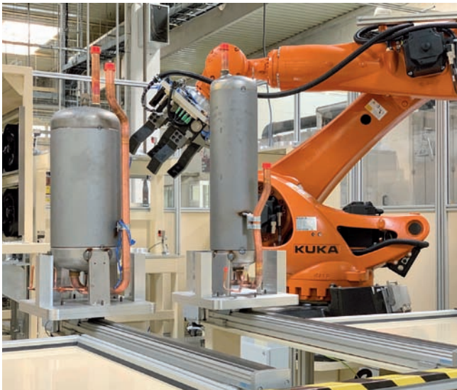
Výzvou bolo vytvorenie univerzálnych čelustí pre robot tak, aby bol schopný manipulovať s trinástimi rôznymi typmi tlakových nádob.
